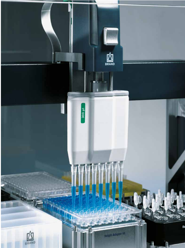
图1 移液工作站使用 (20 - 300) \mu\text{L} 8 通道移液端。
